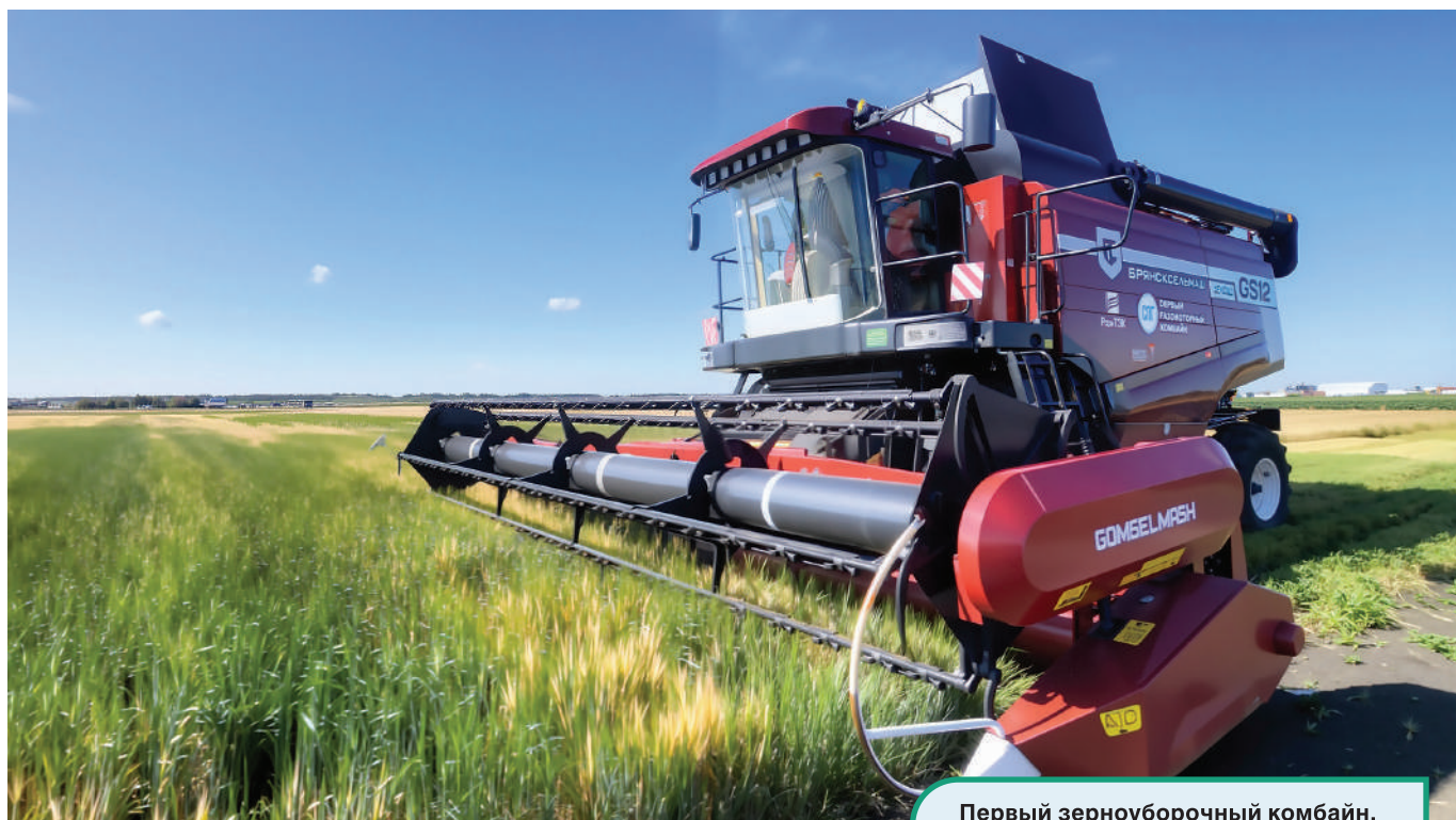
Первый зерноуборочный комбайн, работающий на СПГ – GS12 Делюкс
