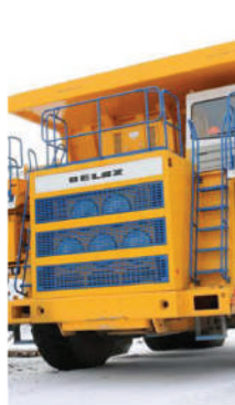
Монотопливный газотурбинный самосвал БЕЛАЗ-75588
