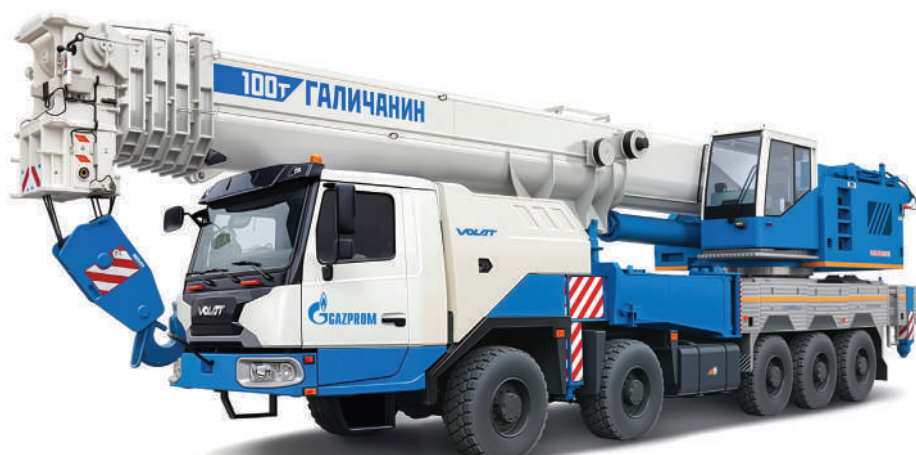
Белорусско-российский автокран грузоподъемностью 100 тонн, сконструированный на базе шасси МЗКТ-740004-010 может стать газовым
