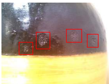
Рисунок 2 – Следы от пузырьков воздуха на композитной оболочке баллона
